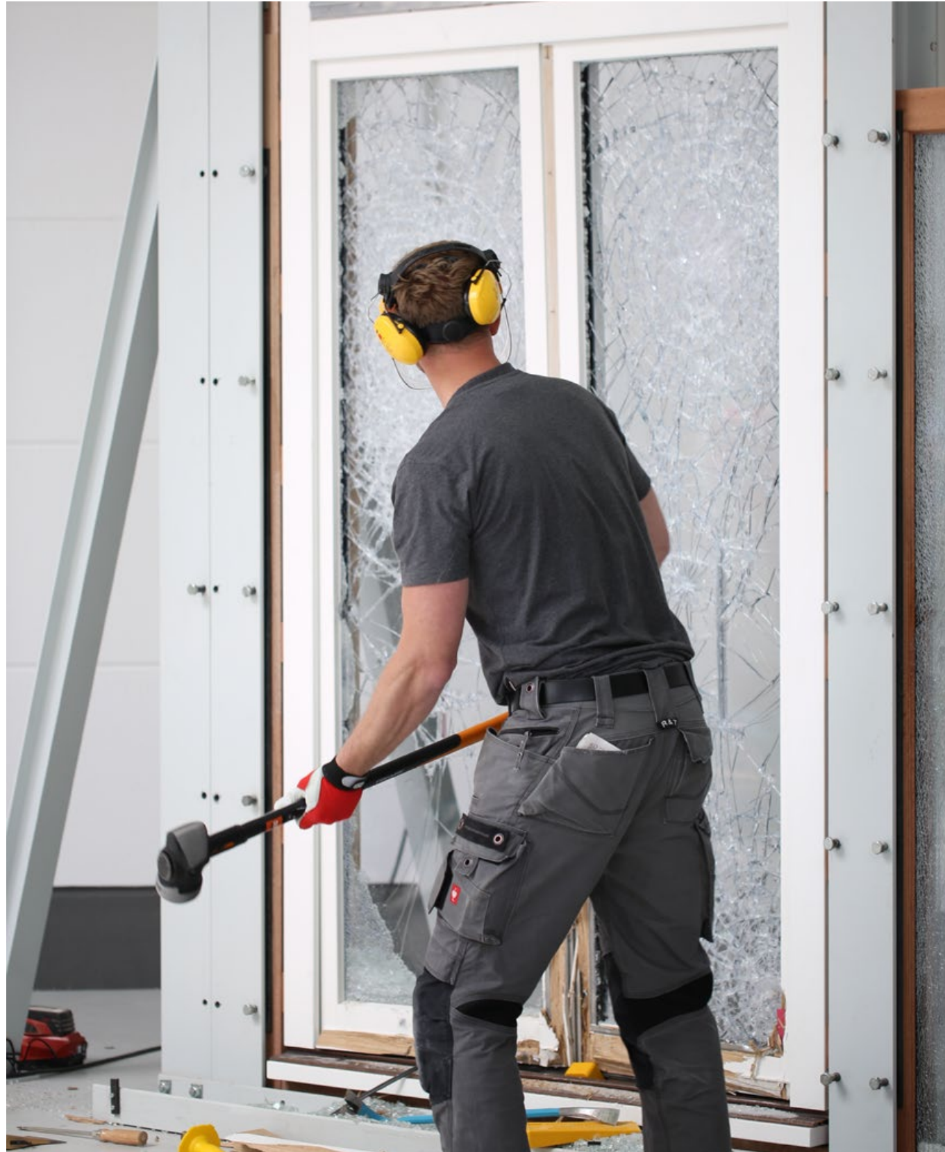
Einbruchprüfung auf dem firmeneigenen Teststand
